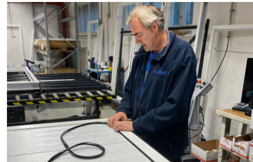
Montering av LOBAS® PORTEN ståldør.
